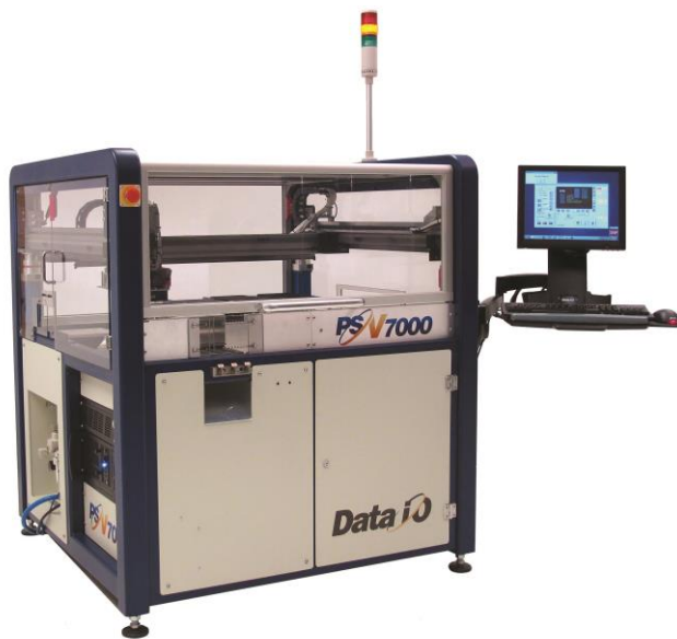
Bestückungsautomat PSV7000 der Firma Data I/O
